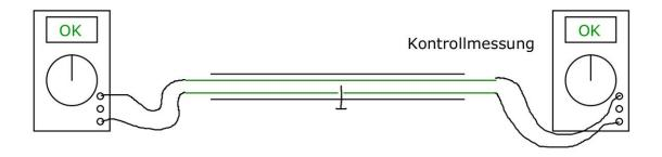
Eine Messung sollte grundsätzlich durch eine weitere Kontrollmessung vom anderen Kabelende bestätigt werden. Die beiden Messwerte müssen sich zur Gesamtlänge des Kabels addieren falls die Ader unterbrochen/kurzgeschlossen ist oder bei beiden Messungen die Gesamtlänge des Kabels betragen falls kein Fehler vorliegt.
