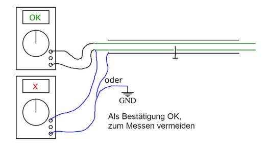
Messwerte sollten möglichst immer durch ein Adernpaar ermittelt werden. Ist z. B. von diesem Adernpaar eine Ader längenmäßig vor der anderen Ader unterbrochen (so wie im Bild, z. B. durch einen Nagel), so wird immer die Entfernung zum Ende der kürzeren Ader ausgegeben.
