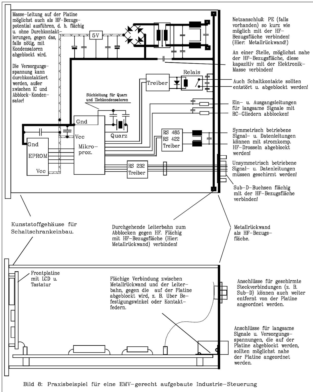
Bild 8: Praxisbeispiel für eine EMV-gerecht aufgebaute Industrie-Steuerung
