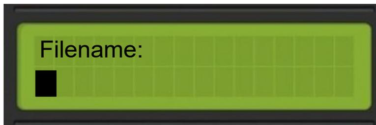
Durch drehen des Endlosreglers(4) können Sie Buchstaben auswählen und durch drücken auf den Endlosregler(4) die nächste Stelle auswählen.
