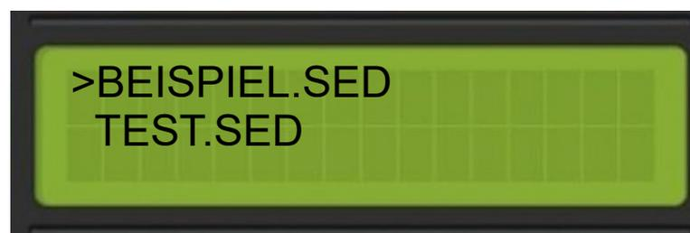
Durch drehen des Endlosreglers(4) können Sie die von Ihnen gewünschte Datei auswählen und mit einem Druck auf den Endlosregler(4) die Datei Laden.
