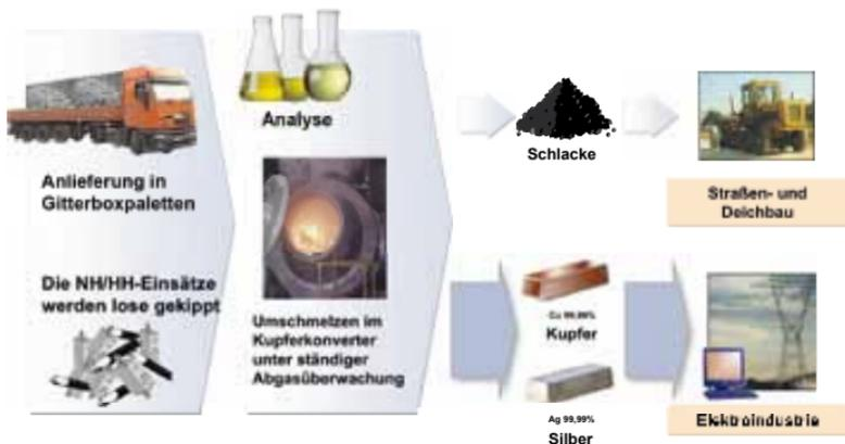
Bild 3.8.5 Recyclingverfahren für NH- und HH-Sicherungen
