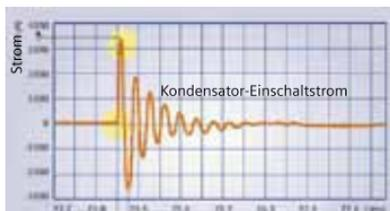
Bild 5.8.2 – Kondensator-Einschaltstrom
