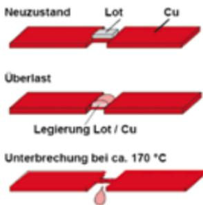
Bild 4.1.5 – Lotreaktion bei Überlastabschaltung
