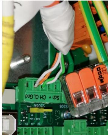
2. Die Netzwerkleitung von Modem zu ETA Hack ist sehr lang und die Schirmung ist nicht geerdet. Ist hier eine galvanische Trennung mit **EMOSafe EN-1005+** sinnvoll?
