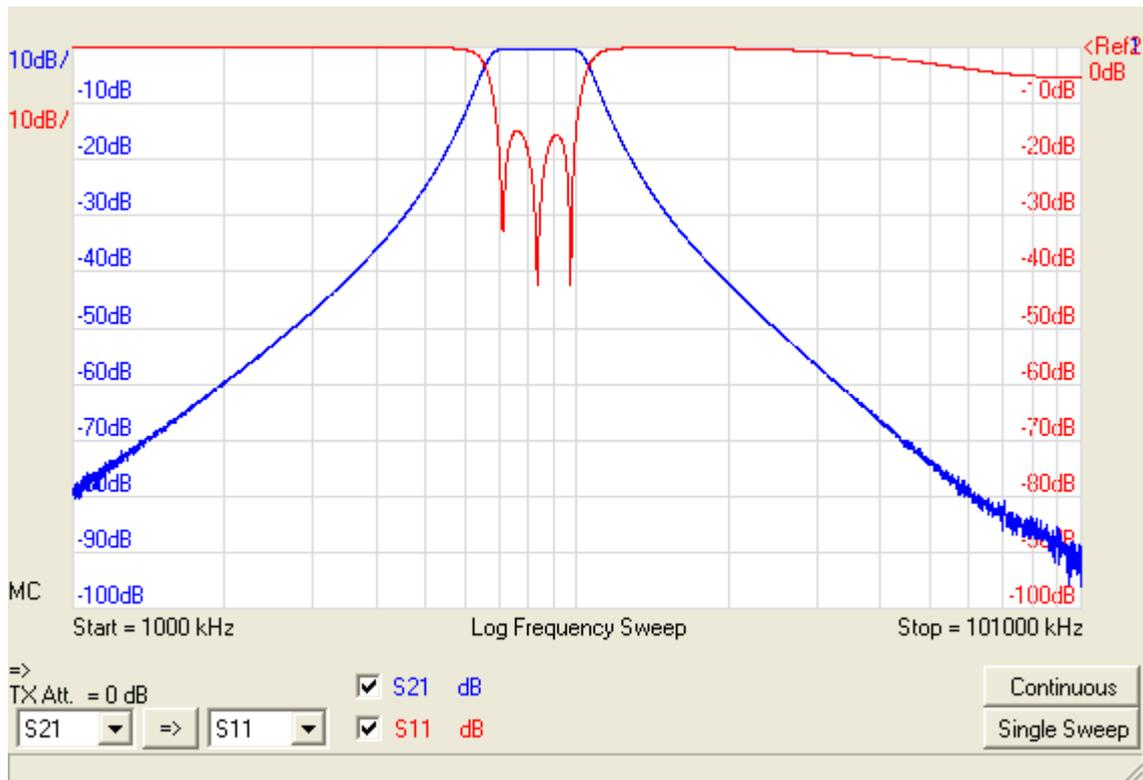
Das Filter zeigt bis 100MHz keine Dämpfungspitze (Notch), wie es auf der Kurve in der Wavestar-Dokumentation bei ca.45MHz zu erahnen ist. Das kann man durchaus als Bestätigung meines Mantras bezüglich Massefläche sehen. (die abfallende S11-Kurve ist auf eine fehlende S11-Kalibrierung oberhalb von 40MHz zurückzuführen).
