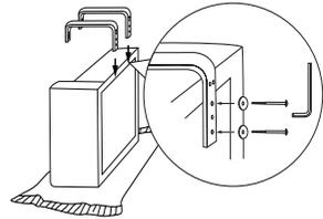
Fertig montierter Bügel:
