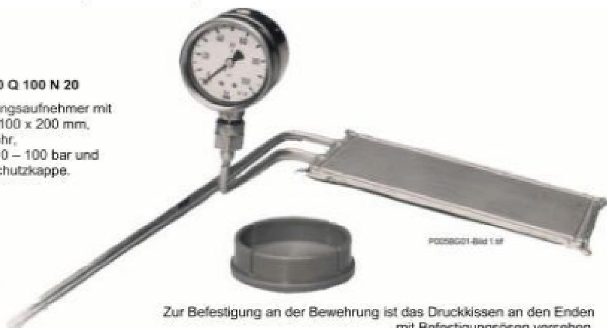
Zur Befestigung an der Bewehrung ist das Druckkissen an den Enden mit Befestigungsösen versehen.
