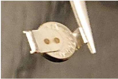
Danach nehme ich einen ganz kleinen Tropfen Lötzinn mit der Lötspitze auf und platziere ihn auf dem Kontakt so dass er sich, wie auf dem Bild, gleichmäßig verteilt und eine kleine Wölbung bildet. Das gleiche mit dem zweiten Kontakt.
