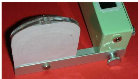
Den Kompass habe ich bei diesem Empfänger mit einem Alu-Winkelprofil unten an den Empfänger geschraubt. Auf das Kompass-Montageloch unten am Empfänger ist von innen eine M3-Mutter gelötet. Wer den Empfänger in der linken Hand hält, sollte den Kompass rechts montieren.
