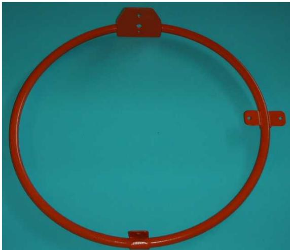
Die Rahmenantenne besteht aus einem rund gebogenen Messingrohr mit 8mm Außendurchmesser, in das eine 10adrige Steuerleitung eingezogen ist.
