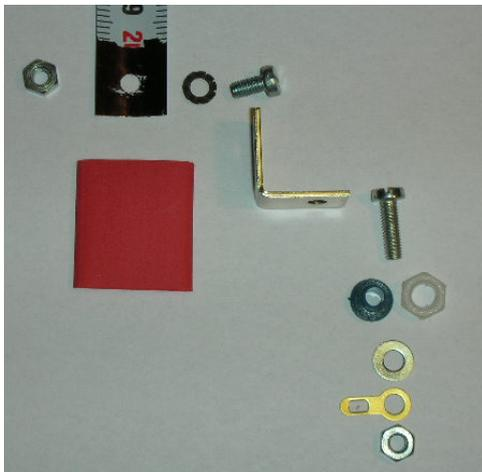
**Die Einzelteile der E-Antenne**
