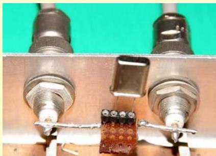
Quarze sollte man nur in Ausnahmefällen (und dann auch nur ganz kurz) direkt zwischen Ausgang und Eingang des NWT schalten. Bei der Ausgangsleistung des NWT von rund 2,5mW werden sie bereits sehr stark belastet. Als Folge davon kann – neben einer temporären Temperaturdrift - schon nach kurzer Zeit eine irreversible Verschlechterung der Quarzgüte eintreten. Die beschriebenen Adapter sorgen für eine ausreichende Pegelreduzierung, erfordern aber natürlich einen Nachverstärker.
