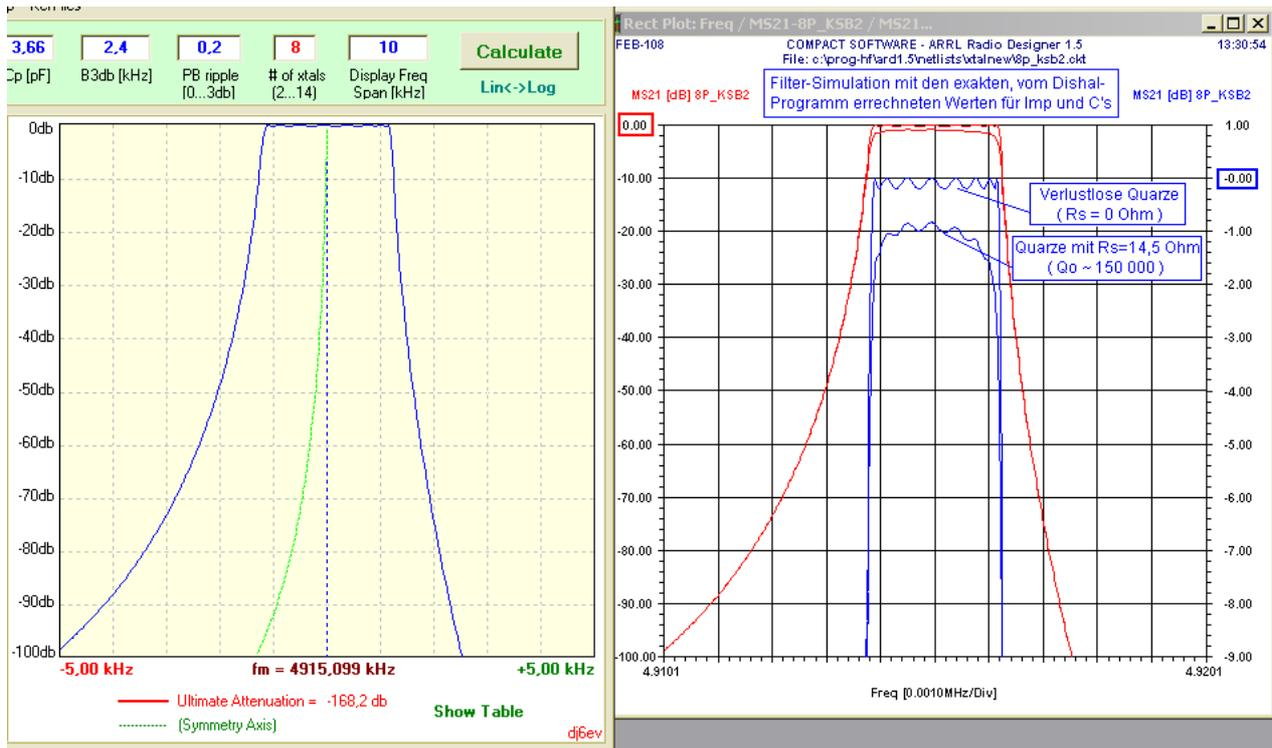
Vergleich zwischen einer berechneten Filterkurve und der entsprechenden Simulation mit den exakten, vom Dishal-Programm erstellten Komponentenwerten. In der Simulation werden zusätzlich die Kurven unter Berücksichtigung von typischen Quarzverlusten dargestellt
