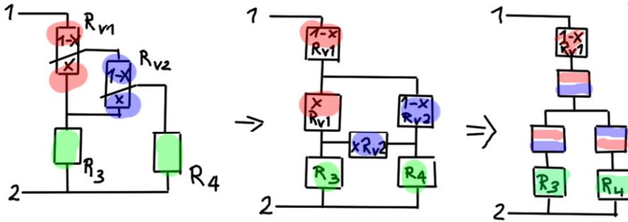
$$R_{G1 \rightarrow 2} = (1-x) \cdot R_{v1} + \frac{x \cdot R_{v1} \cdot (1-x) \cdot R_{v2}}{x \cdot R_{v1} + (1-x) \cdot R_{v2} + x \cdot R_{v2}} + \left( \frac{x \cdot R_{v1} \cdot x \cdot R_{v2}}{x \cdot R_{v1} + (1-x) \cdot R_{v2} + x \cdot R_{v2}} + R_3 \right) \cdot \left( \frac{(1-x) \cdot R_{v2} \cdot x \cdot R_{v2}}{x \cdot R_{v1} + (1-x) \cdot R_{v2} + x \cdot R_{v2}} + R_4 \right)$$
