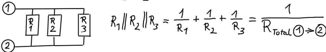
$$G = \frac{1}{R_T} = \frac{1 \cdot R_2 \cdot R_3}{R_1 \cdot R_2 \cdot R_3} + \frac{1 \cdot R_1 \cdot R_3}{R_2 \cdot R_1 \cdot R_3} + \frac{1 \cdot R_1 \cdot R_2}{R_3 \cdot R_1 \cdot R_2} = \Rightarrow$$
