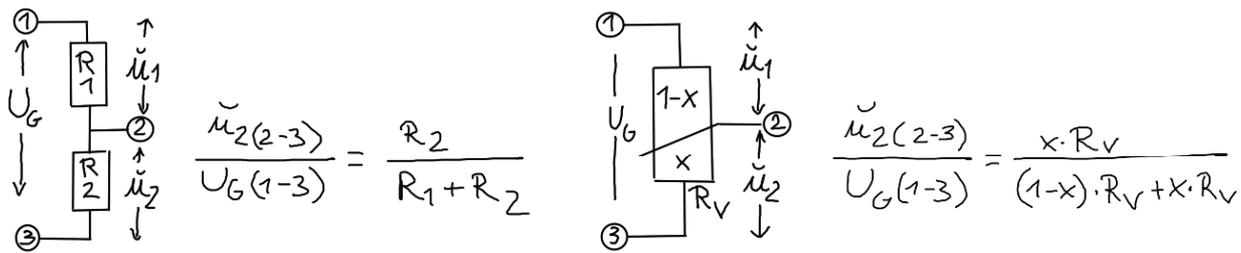
der variable widerstand stellt einen spannungsteiler dar . die position des schleifkontaktes (x) auf der gesamten widerstandslänge (o.dem maximalen drehwinkel) wird als ein wert zwischen 0 und 1 angenommen , um den entsprechenden widerstandswert oder seine teilspannung als eine funktion von x auszugeben.
