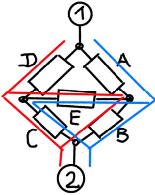
um bei der berechnung von mehrfach parallelen strompfaden eine doppelberechnung des querwiderstandes E zu verhindern, wird eine dreieck-stern-umwandlung des widerstandnetzes vorgenommen. siehe: äquivalente stern-dreieck-umrechnungen; <https://www.elektroniktutor.de/analogtechnik/stdrumw.html>
