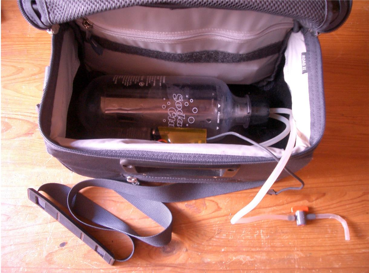
Die Luftpumpe stammt aus einem Blutdruckmeßgerät und der Bierhahn kommt von Gardena. Nun bekommt die Druckflasche noch eine Isolierung aus Polyurethanschaum. Mit dieser Erfindung kann so manch einer mehrere hundert Euro im Monat sparen! So, jetzt ziehe ich mal los – erst in den Supermarkt und dann ab in den Biergarten.
