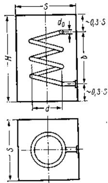
Bild 78. Abmessungen eines Spulenresonators
