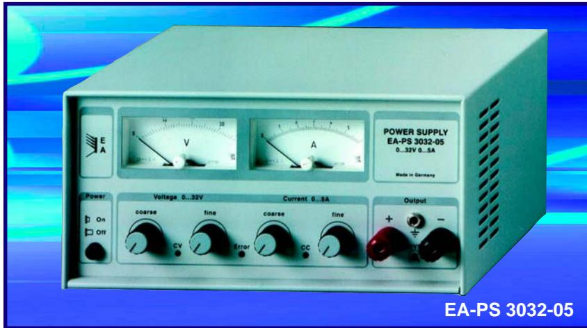
Die Ausgangsleistung liegt zwischen 80 und 320Watt. Die Geräte können als Konstantspannungsquelle oder als Konstantstromquelle eingesetzt werden. Strom und Spannung sind von 0 bis zum Nennwert einstellbar. Die Geräte sind für 100% ED in allen Betriebsbereichen konzipiert. Die Geräte haben keine Öffnungen auf Ober- und Unterseite. Die Ausgangsspannung steht an Sicherheitsbuchsen zur Verfügung. Der einstellbare Überspannungsschutz (OVP) schützt die Lasten vor zu hohen Spannungen.
