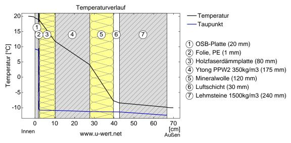
Verlauf von Temperatur und Taupunkt innerhalb des Bauteils. Der Taupunkt kennzeichnet die Temperatur, bei der Wasserdampf kondensieren und Tauwasser entstehen würde. Solange die Temperatur der Konstruktion an jeder Stelle über der Taupunkttemperatur liegt, entsteht kein Tauwasser. Falls sich die beiden Kurven berühren, fällt an den Berührungspunkten Tauwasser aus.
