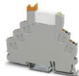
Vormontiertes Relaismodul mit Push-in-Anschluss, bestehend aus: Relaissockel mit Auswerfer und Leistungskontaktrelais. Kontaktausführung: 1 Wechsler. Eingangsspannung: 12 V DC
