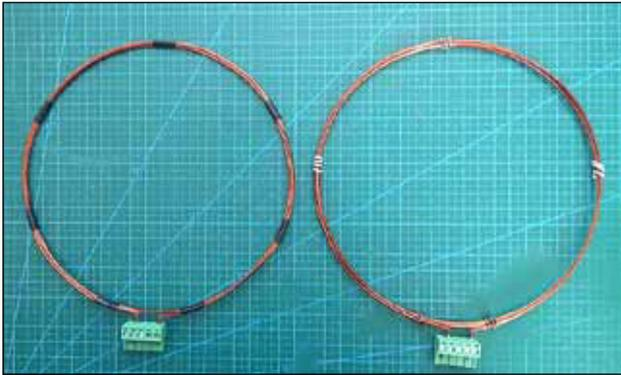
**Abbildung 3: Zwei Spulen mit je 3 Windungen, aus isoliertem Kupferdraht gewickelt** (siehe Text)
