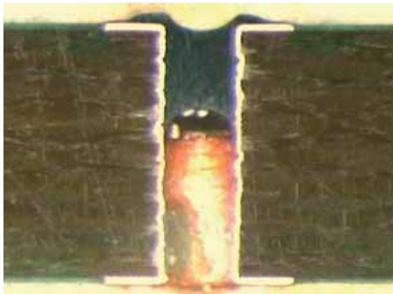
Abbildung: mit Lochfüller verschlossene Durchgangsbohrung
