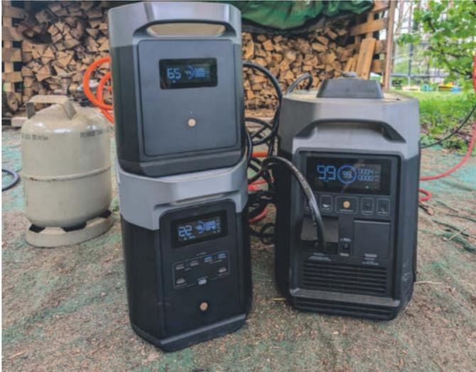
**Notstrom Deluxe:** Die Geräte von Ecoflow lassen sich kombinieren und per App steuern. Die tragbare Pufferbatterie Delta 2 Max (links unten) mit Speichererweiterung (links oben) speichert 4 kWh. Läuft sie leer, springt der per LPG betriebene Smart Generator automatisch an und lädt nach.
