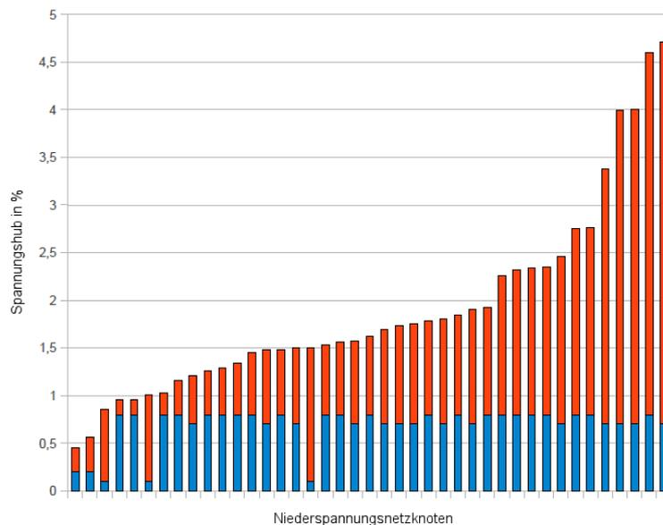
**Abbildung 4: Spannungsanhebung an ausgewählten Niederspannungsknoten im Untersuchungsgebiet. In rot gezeigt ist die Anhebung aus dem untersuchtem Niederspannungsnetz, in blau die Rückwirkung der anderen Netzbereiche über das Mittelspannungsnetzes.**
