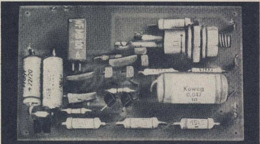
Bild 6.3. a — Vollständiger, potentialgetrennt über Optokoppler steuerbarer Netzspannungsschalter für Lasten mit induktivem Anteil (z. B. Fernsehempfänger), b — Versuchsleiterplatte zu a, c — Einzelheit „Abschotten“. Achtung Netzspannung — Bau nur für Sachkundige zulässig!
