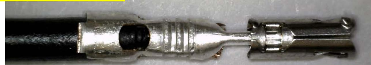
Kontaktstellen lassen sich bei Steckergehäuse in beiden Fällen gut einführen
