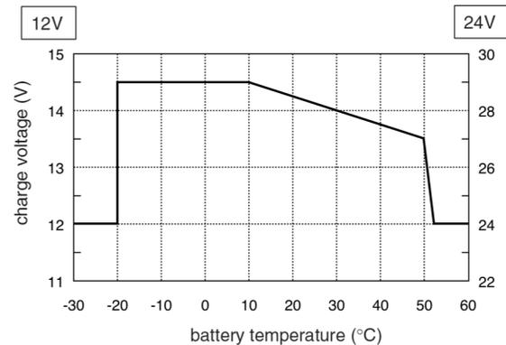
Abbildung 4: Laden mit Temperatenausgleich
