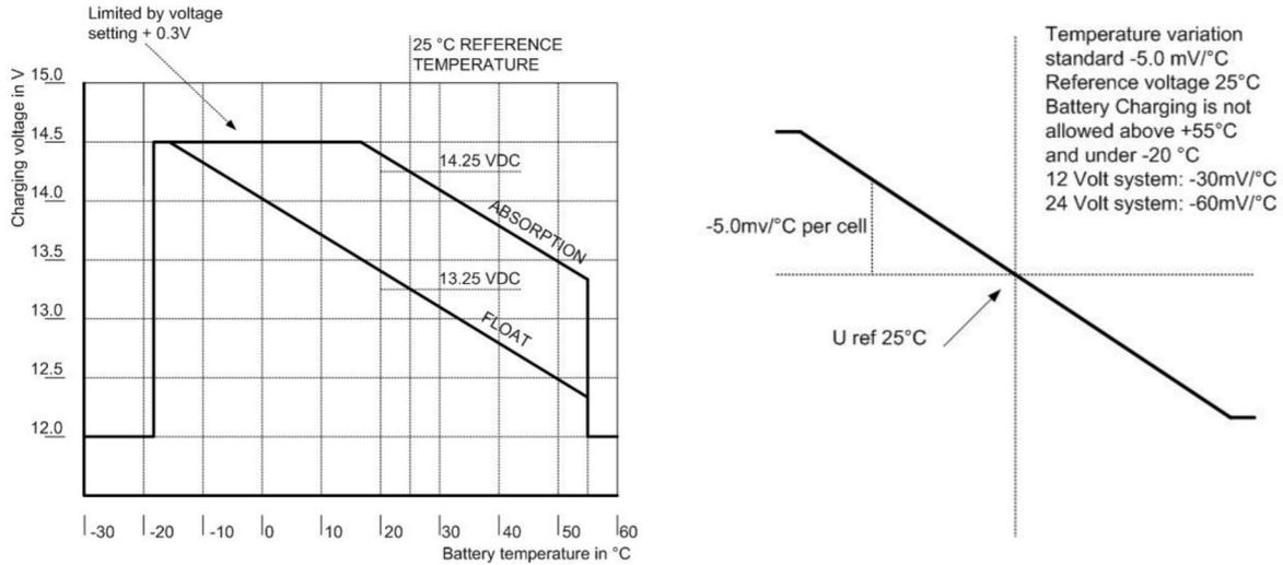
Abbildung 16: Kennlinie des Temperatenausgleichs (Ladespannung im Vergleich zur Temperatur)
