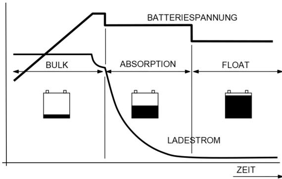
Abbildung 3: Dreistufen-Plus-Ladesystem
