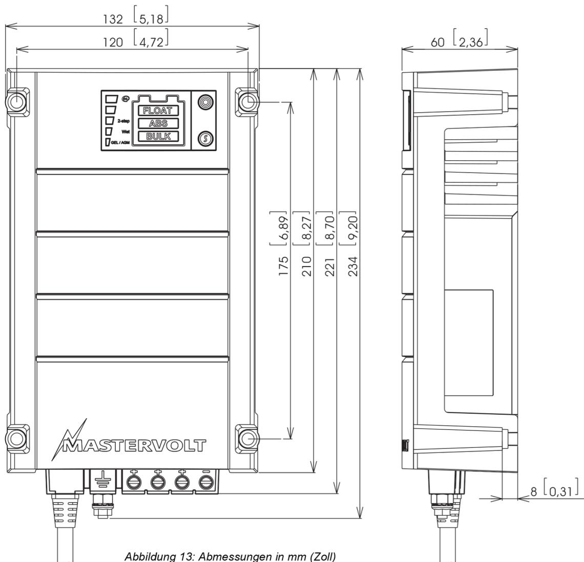
Abbildung 13: Abmessungen in mm (Zoll)
