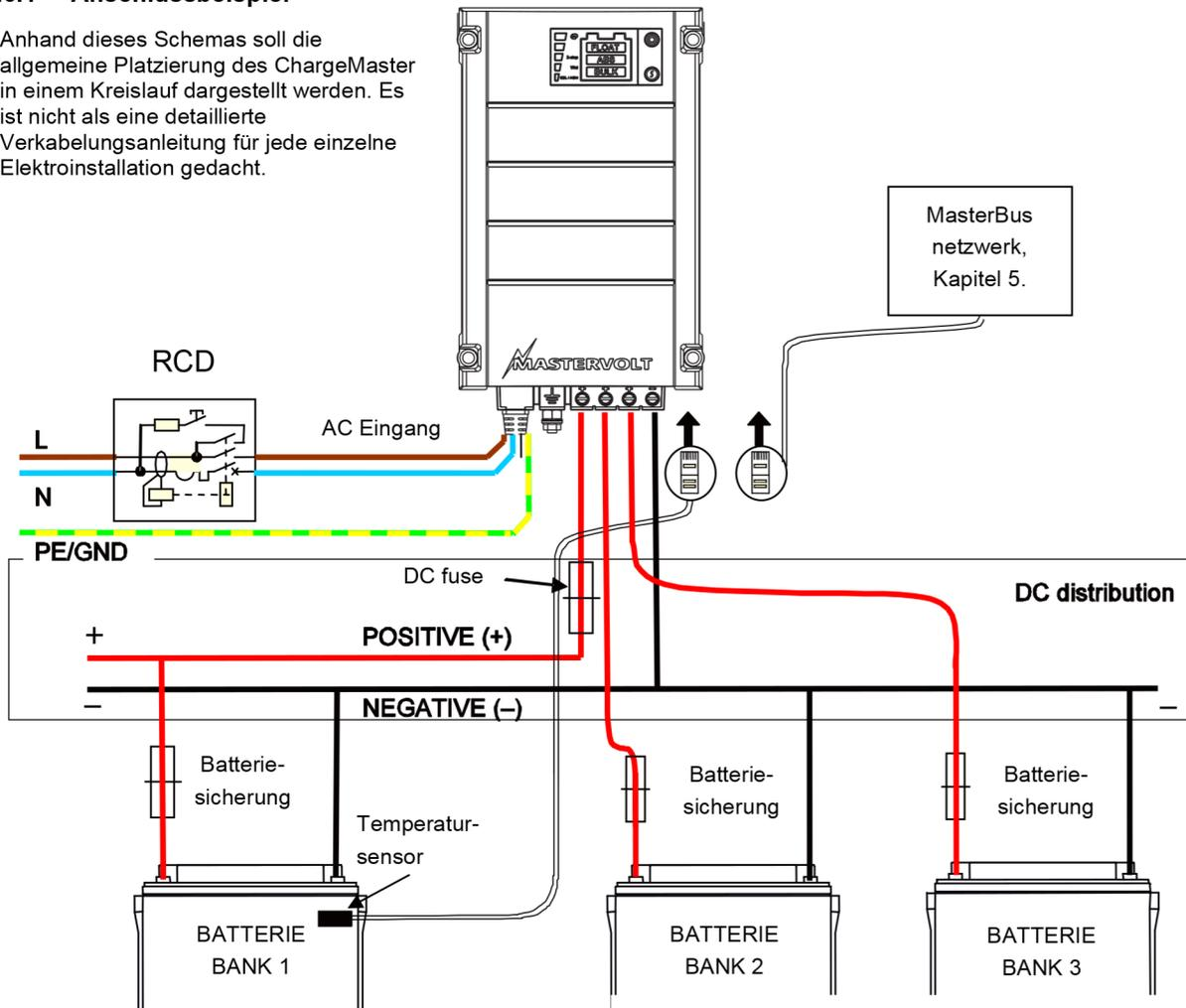
Abbildung 6: Installationszeichnung des ChargeMaster
