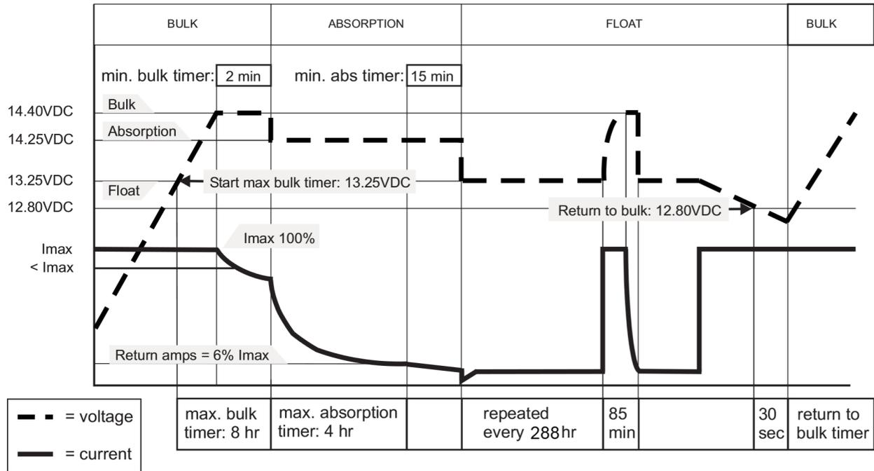
Abbildung 15: Ladekennlinie der Dreistufen-Plus-Lademethode (@ 25°C / 77°F)
