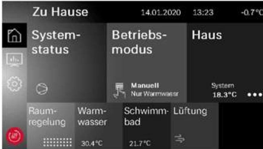
Abb. 7.1: Displayanzeige Wärmepumpenmanager mit Touch-Display (pGDx)
