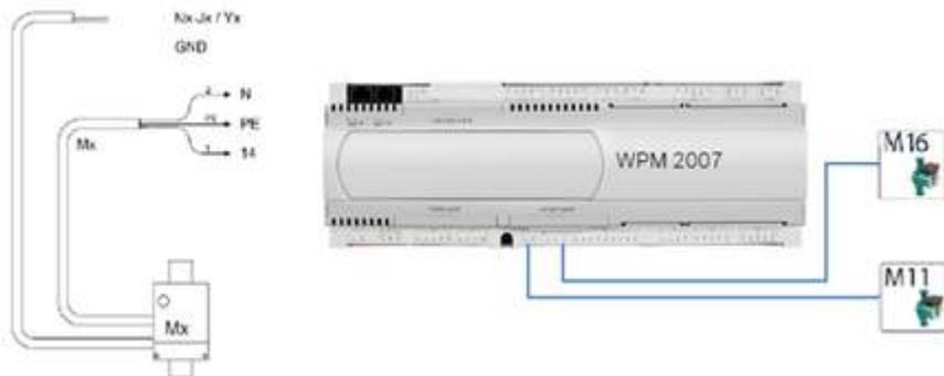
Abb. 7.46: Elektrische Verdrahtung Steuersignal 0 - 10V am WPM 2006/2007Plus
