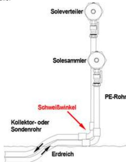
Abb. 3.7: Montage der Rohrleitungen mit Schweißwinkel am Soleverteiler
