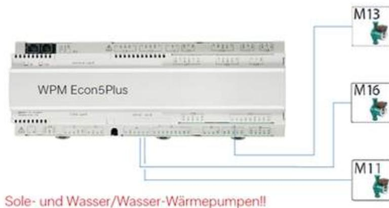
Abb. 7.49: Elektrische Verdrahtung Steuersignal 0 - 10V und PWM für Sole/Wasser-Wärmepumpen am WPM Econ5Plus
