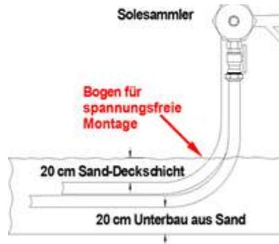
Abb. 3.6: Montage der Rohrleitungen am Soleverteiler
