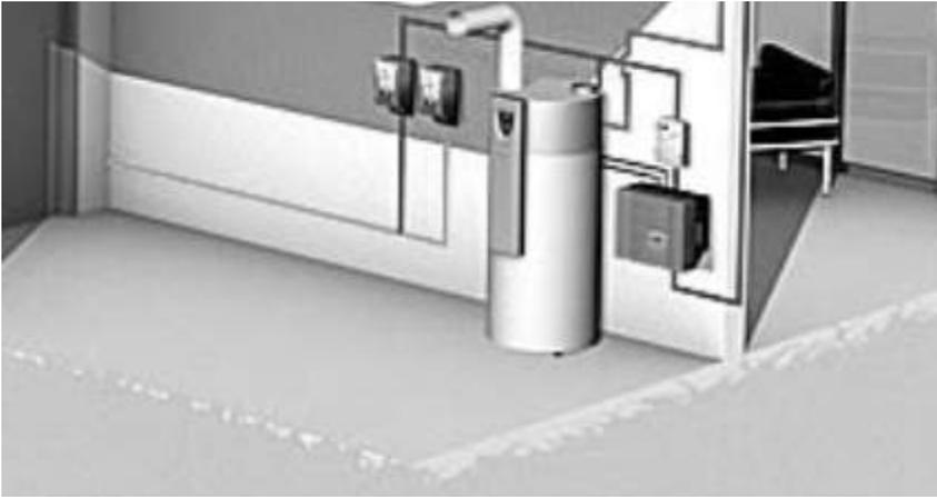
Abb. 6.21: Warmwasser-Wärmepumpe kombiniert mit einer Photovoltaik-Anlage
