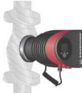
Abb. 7.76: Dämmung bauseits! Niemals die Elektronikinheit dämmen!
