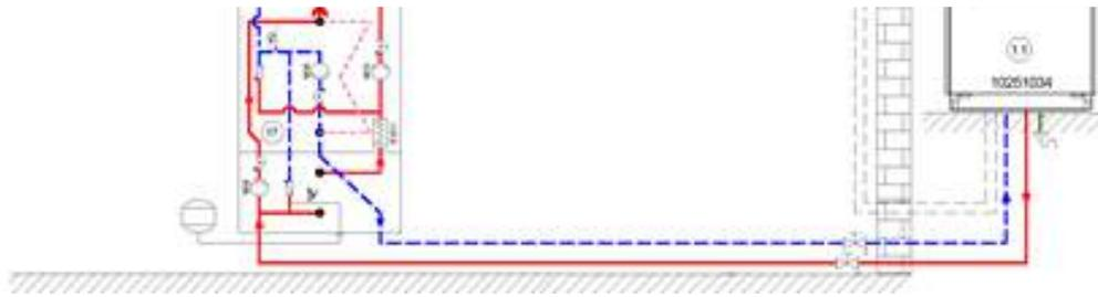
Abb. 8.58: Einbindungsschema einer außen aufgestellten Luft/Wasser-Wärmepumpe mit Hydro-Tower HWK 332 Econ
