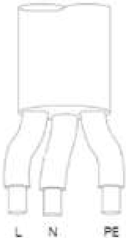
Steuerkabel: 3 x 0,75 mm<sup>2</sup> PWM Signal
