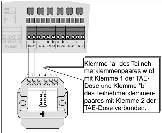
Die Belegung einer handelsüblichen TAE-Anschlussdose (F-Codierung) ist im folgenden Bild dargestellt. Es werden nur die beiden Anschlüsse 1 (La) und 2 (Lb) der TAE-Anschlussdose mit den Teilnehmerklemmen a und b des ETS-2106 I Rev. 2 verbunden.
