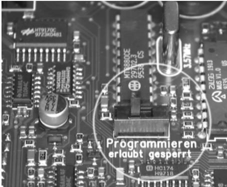
Der Programmierschalter in der Anlage muss in Stellung „Programmieren erlaubt“ stehen, wenn das ETS-2106 I Rev. 2 per Telefon oder per ISDN-PC-Karte programmiert wird.
