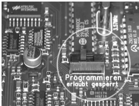
Der Programmierschalter in der Anlage muss in Stellung „Programmieren erlaubt“ stehen, wenn Sie das ETS-2106 I Rev. 2 per Telefon oder per ISDN-PC-Karte programmieren wollen.
