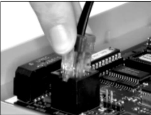
Am Tk-Anlagenanschluss (Point To Point = PTP) dürfen Sie nur **ein** ISDN-Gerät, in diesem Fall also nur Ihr ETS-2106 I Rev. 2, betreiben. Alle weiteren Geräte werden an das ETS-2106 I Rev. 2 angeschlossen. Der Anschluss des ETS-2106 I Rev. 2 an das ISDN erfolgt über eine der IAE-Steckdosen (ISDN-Anschluss-Einheit) an der unteren Stirnseite des NTBA. Sie benötigen dazu das im Lieferumfang enthaltene ISDN-Kabel mit zwei gleichen Steckern (so genannten Westernsteckern RJ 45) an beiden Enden.
