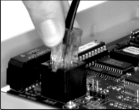
Um Ihr ETS-2106 I Rev. 2 am ISDN anzuschließen, benötigen Sie das mitgelieferte ISDN-Kabel mit zwei gleichen Steckern (so genannten Westernsteckern RJ 45) an beiden Enden. Sie können Ihr ETS-2106 I Rev. 2 entweder an eine der beiden IAE-Steckdosen Ihres NTBA anschließen oder, wenn Sie sich an Ihrem NTBA einen S<sub>0</sub>-Bus haben legen lassen, eine der daran vorhandenen IAE-Steckdosen nutzen.
