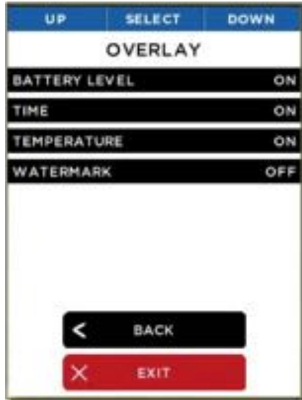
Die folgenden Overlays können aktiviert und deaktiviert werden: „BATTERY LEVEL“ (Akkustand), „TIME“ (Uhrzeit), TEMPERATURE (Temperatur) und WATERMARK (Wasserzeichen).
