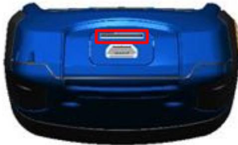
*Abbildung 41: Reveal mit geöffneter Rückklappe und markiertem microSD-Karten-Steckplatz.*
