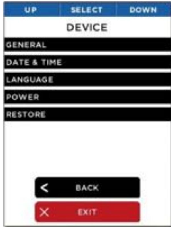
Abbildung 20: Der Bildschirm „DEVICE“ für die Geräteeinstellungen
