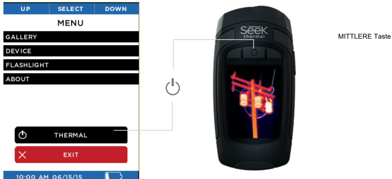
Abbildung 35: Wärmebildfunktion ausschalten
