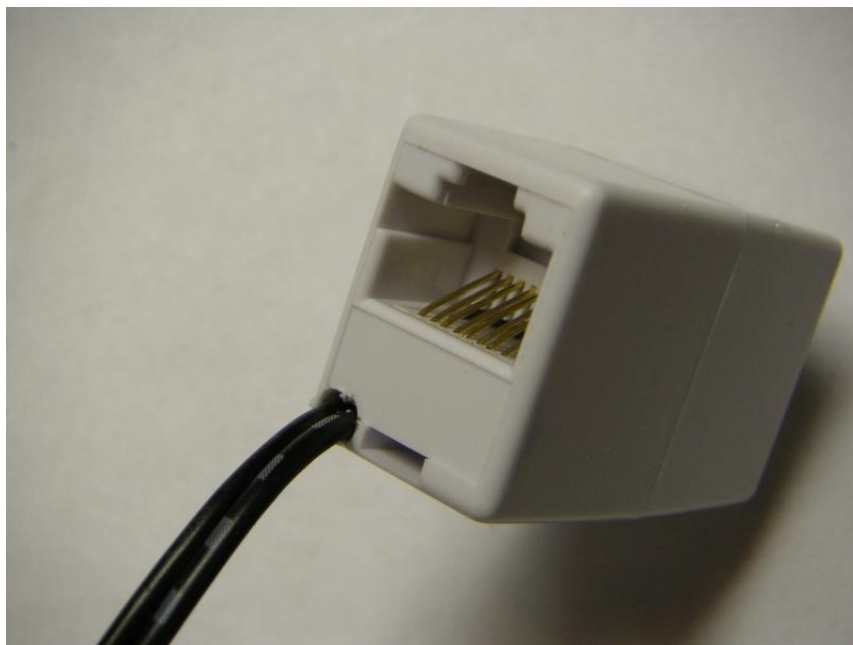
Abbildung 2.11: Als Variante gebohrt. Das Kabel vor dem Lötten durch das Loch fädeln!
