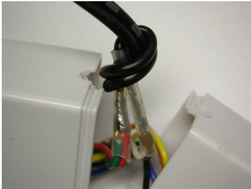
Abbildung 2.10: Als Zugentlastung reicht ein kleiner Knoten.
