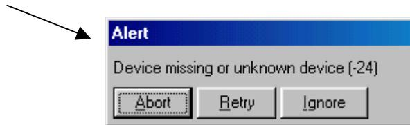
Der Programmer ist nicht oder nicht ordnungsgemäß angesteckt, der Programmer ist defekt (falsch verdrahtet), die Spannung am Controller fehlt, oder die Einstellungen laut Seite 1 dieser Beschreibung sind nicht korrekt. Das Verbindungskabel ist nicht voll verdrahtet.
