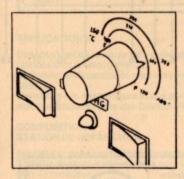
Selectionnez la température adéquate au circuit et le composant que vous devez dessouder/souder. Le LED du tableau de commande restera allumé jusqu'à ce que la panne atteigne la température choisie, en s'alumant d'une façon intermittente à partir du moment où elle sera atteinte.
