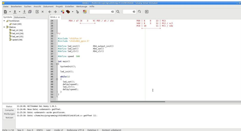
Um Programme von **Geany** heraus zu compilieren und eine erzeugte Binärdatei zu flashen muß / sollte man **Geany** für einen Build-Prozess konfigurieren. Hierfür startet man **Geany** und lädt eine \*.c Datei in den Editor, damit **Geany** den Dateityp kennt.
