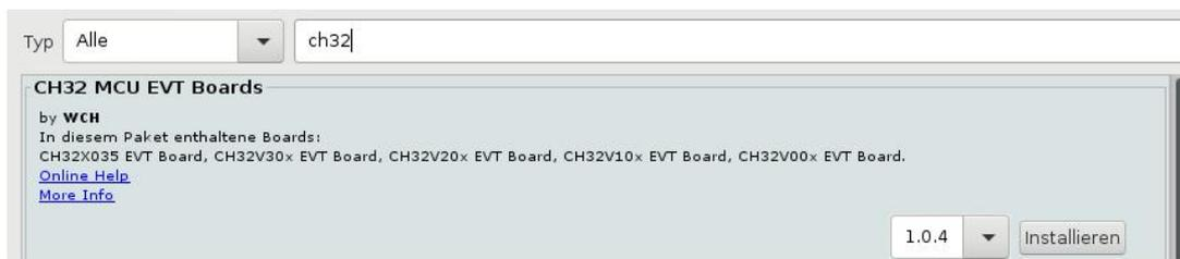
Klicken sie auf „Installieren“. Dieser Vorgang kann etwas dauern, da Arduino nicht nur den Core, sondern die gesamte Toolchain-Kette (inklusive Compiler) installiert.
