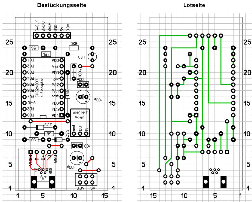
**Hinweis:** Der CH32V003 im TSSOP-20 Gehäuse, die Mini-USB Buchse sowie der Spannungsregler AMS1117 3.3 sind auf PCB-Adaptern zu verlöten und diese Adapter dann auf der Lochrasterkarte zu verbauen. Beim Aufbau darauf achten, von den niedrigen Bauteilen zu den höheren Bauteilen zu Bestücken. Am Besten wird mit den Lötbrücken angefangen.
