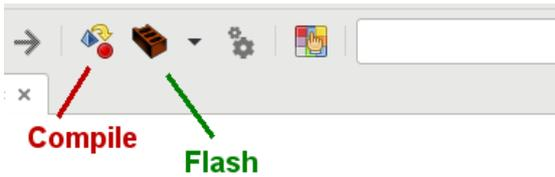
**Geany** kann jetzt aus dem Programm heraus eine Quelldatei übersetzen und eine Binärdatei in den CH32V003 übertragen. In der Symbolleiste von **Geany** gibt es 2 Symbole (siehe Bild links). Ein Klick auf das erste Symbol compiliert die Datei (alternativ kann zum Compilieren auch die Taste F8 gedrückt werden), ein Klick auf das zweite Symbol flasht den Chip (alternativ
