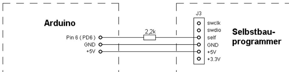
Um die Firmware zu flashen verbindet man Pin 6 / PD6 des Arduino's über einen 2,2kΩ Serienwiderstand mit dem self-Anschluß des Selbstbauprogrammers. Der 5V und Masseanschluß GND des Arduino's ist ebenfalls mit dem Selbstbauprogrammer zu verbinden.
