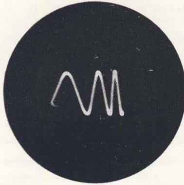
Im dargestellten *Oszillogramm* erkennen wir drei volle Perioden der Spannung von 50 Hz. Die *Kippfrequenz* muß demnach ein Drittel der Frequenz der Meßspannung betragen, also  $16\frac{2}{3}$  Hz. Bild 105 veranschaulicht, wie sich eine ideale Kipperschwingung und eine sinusförmige Wechselspannung zum Schirmbild überlagern.
