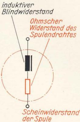
Abschließend sei auf eine kleine Ungenauigkeit hingewiesen. Der Wechselstrom- oder Scheinwiderstand einer Spule oder eines Kondensators ist nicht genau gleich dem induktiven bzw. kapazitiven Widerstand. Der Elektrotechniker unterscheidet deshalb zwischen dem Scheinwiderstand  $\frac{U_{\sim}}{I_{\sim}}$ , dem Ohmschen Widerstand oder Wirkwider-
