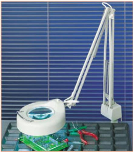
**Bild 13: Eine gute Lupenleuchte hilft beim Platzieren und Lötten.**
