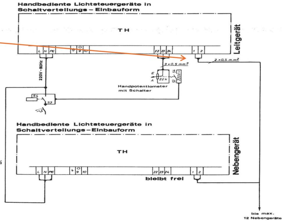
Handbediente Lichtsteuergeräte für Glühlampen in Schaltverteilungs-Einbauform, 3ph:
