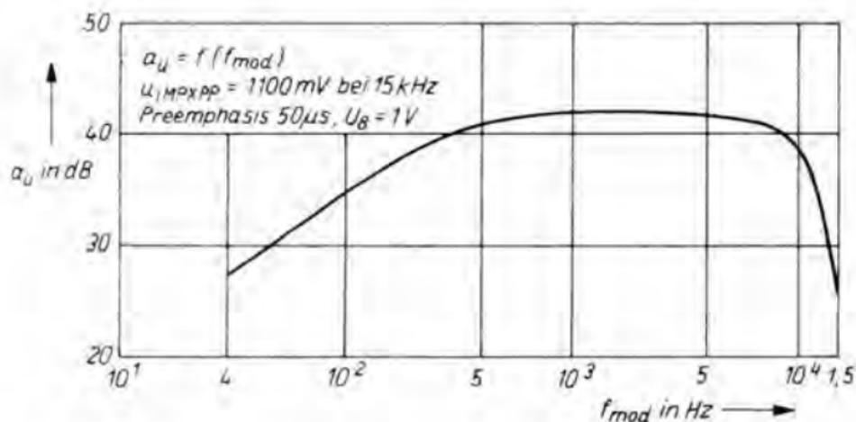
Bild 2.23 Übersprechdämpfung als Funktion der Modulationsfrequenz
