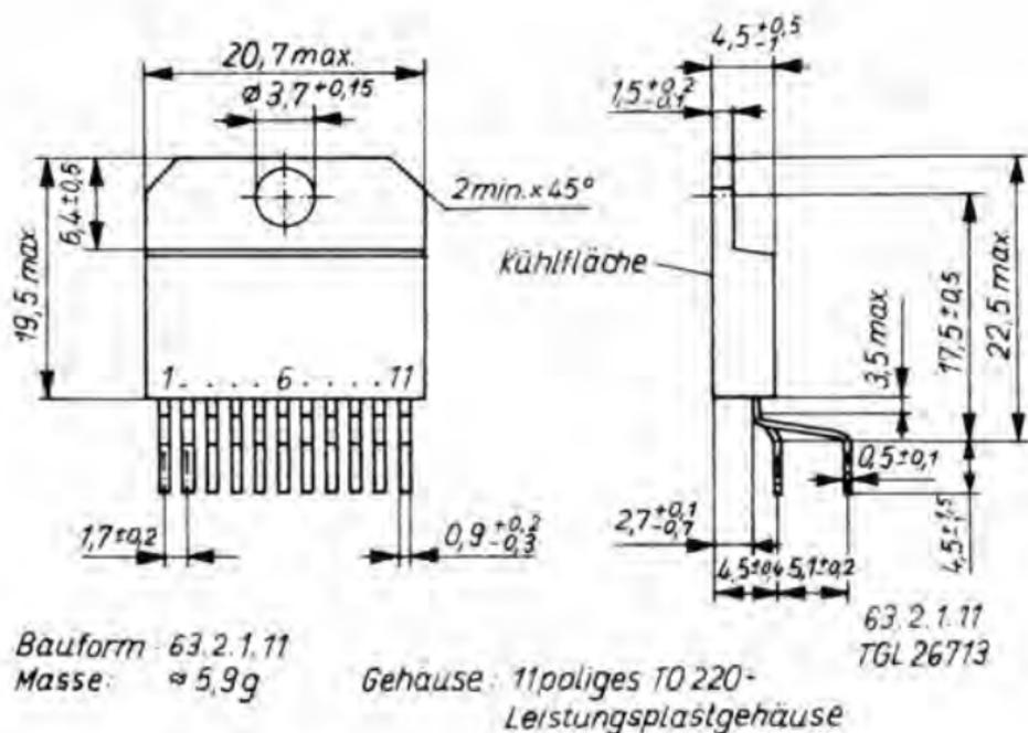
Bild 2.40 Gehäuseskizze A 2000 V, A 2005 V
