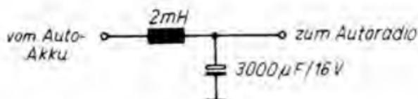
Bild 2.51 LC-Filter für zusätzliche Störunterdrückung beim Einsatz der A 2005 V im Kraftfahrzeug
