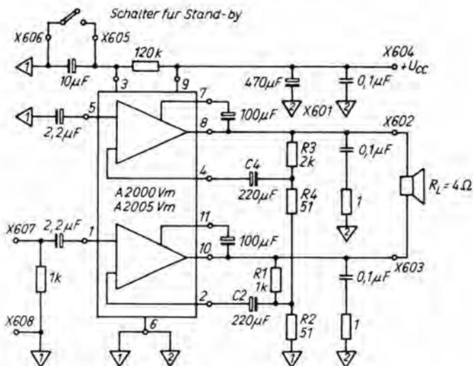
Bild 2.44 Schaltung eines Mono-Brückenverstärkers mit A 2000 Vm/ A 2005 Vm (Baugruppe A6)
