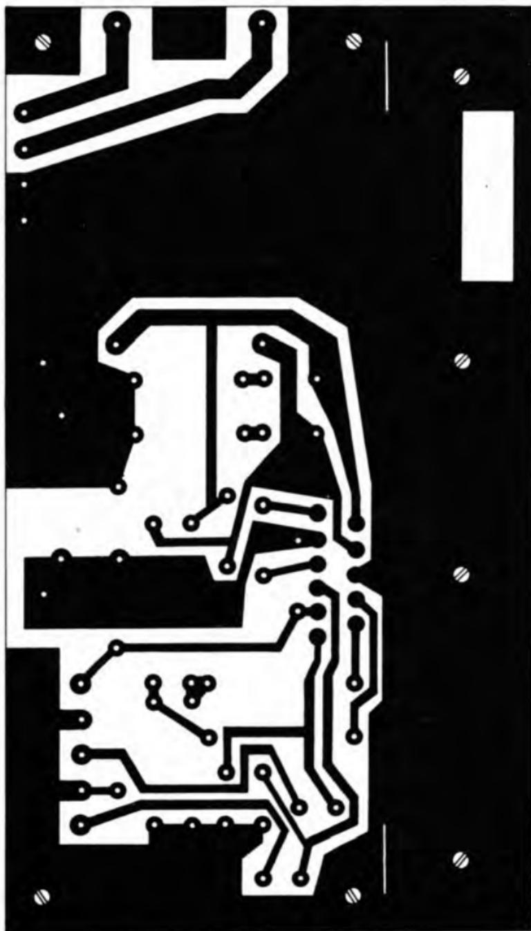
Bild 2.42 Leiterplatte für den Stereo-NF-Verstärker (Baugruppe A5)
