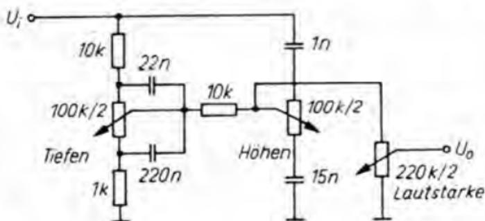
Bild 2.35 Passiver Klangeinsteller (ein Kanal)
