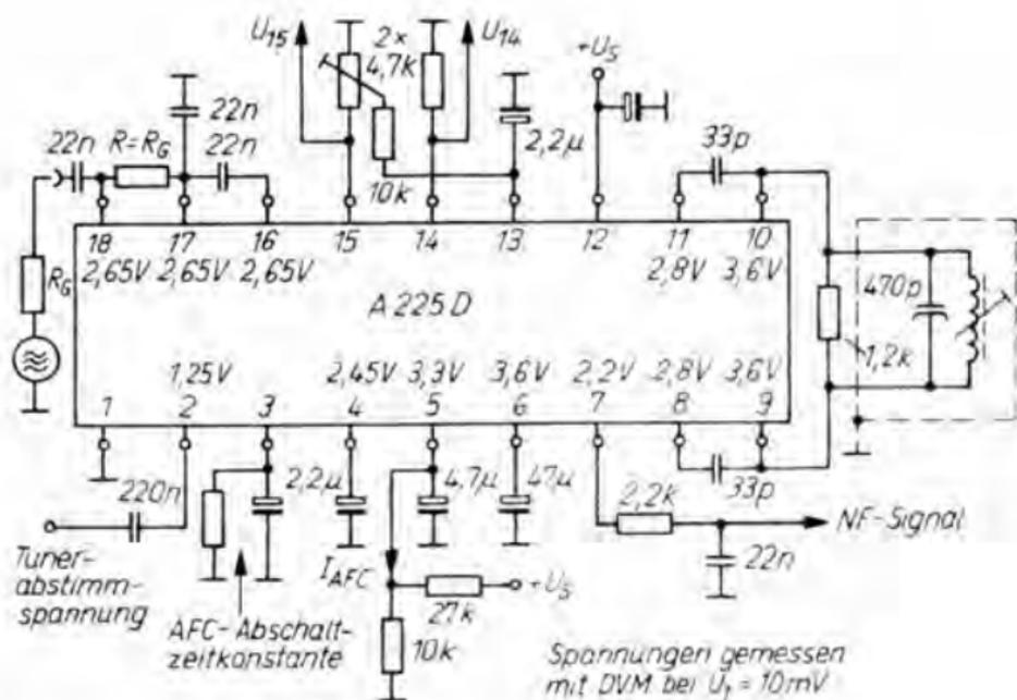
Bild 2.12 Meß- und Anwendungsschaltung des A 225 D
