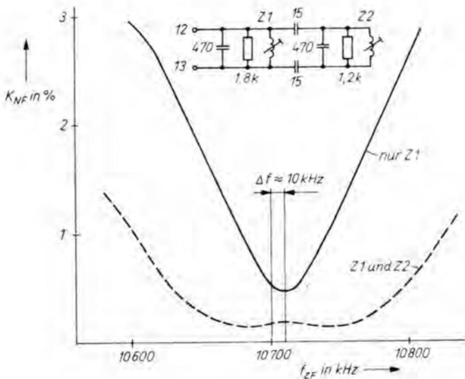
Bild 2.6 Klirrfaktor im FM-Betrieb bei Abgleich auf  $I_{AF1} = 0$  bei  $f_{ZF} = 10700$  kHz
