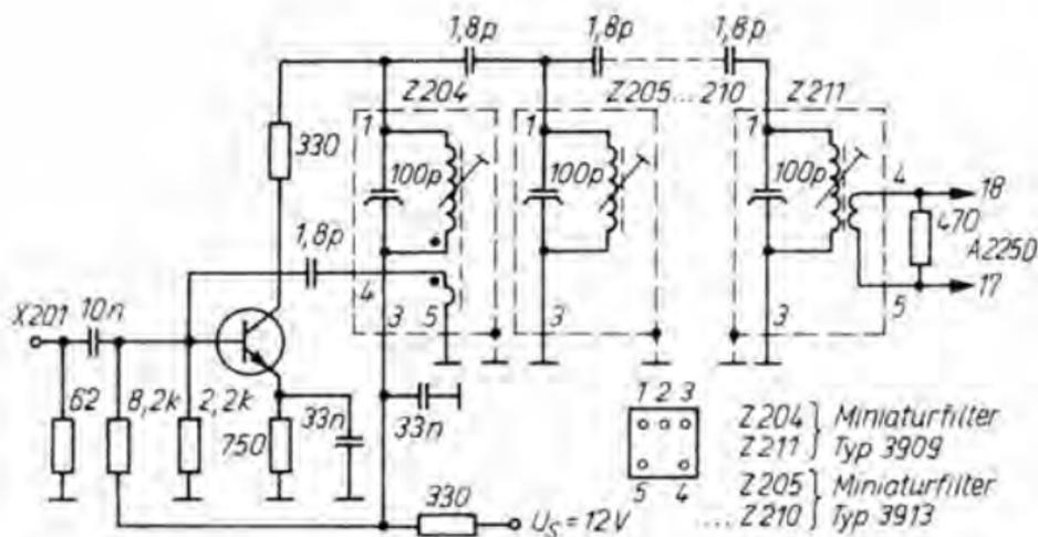
Bild 2.20 8-Kreis-LC-Filter mit Vorverstärker
