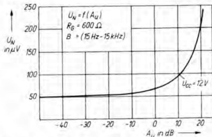
Bild 2.34 Verlauf der Ausgangsrauschspannung über  $A_u$
