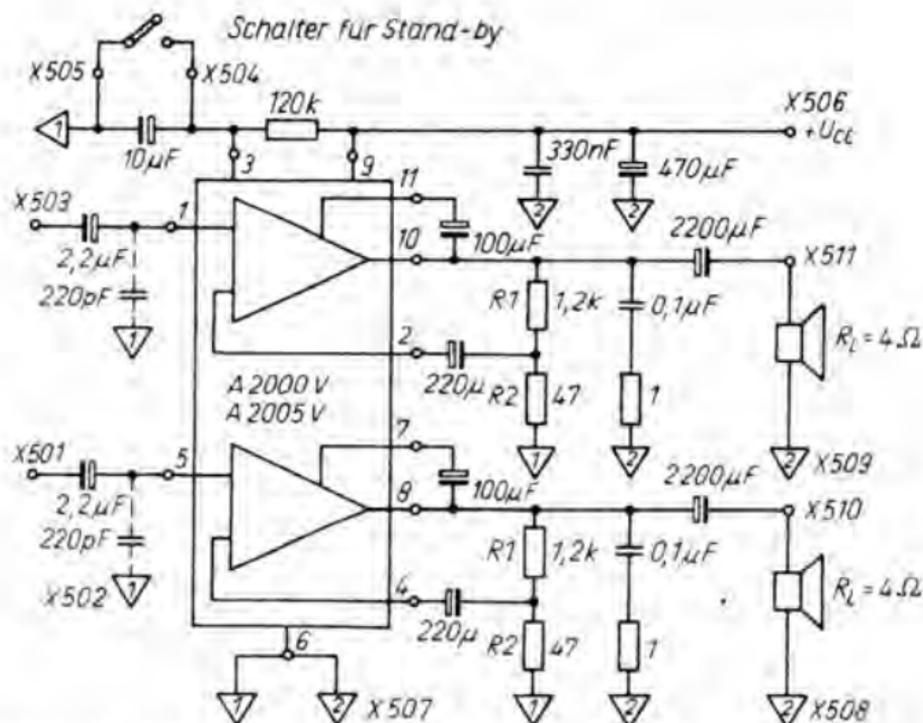
Bild 2.41 Schaltung eines Stereo-NF-Verstärkers mit A 2000 V/
