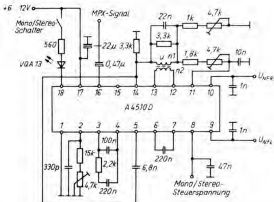
Bild 2.28 Frequenzmultiplexdeko­der mit A 4510 D
