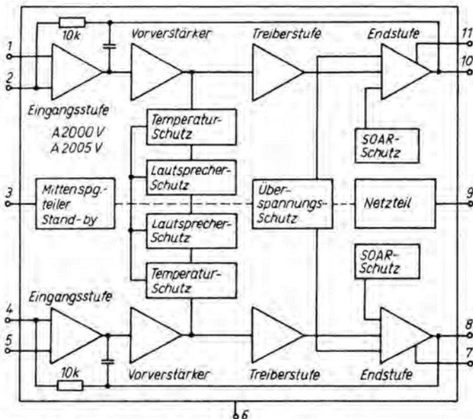
Bild 2.39 Übersichtsschaltplan A 2000 V, A 2005 V
