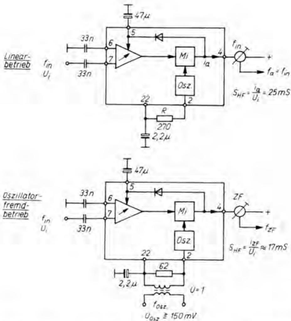
Bild 2.7 Linear- und Oszillatorfremdbetrieb bei AM für den A 4100 D
