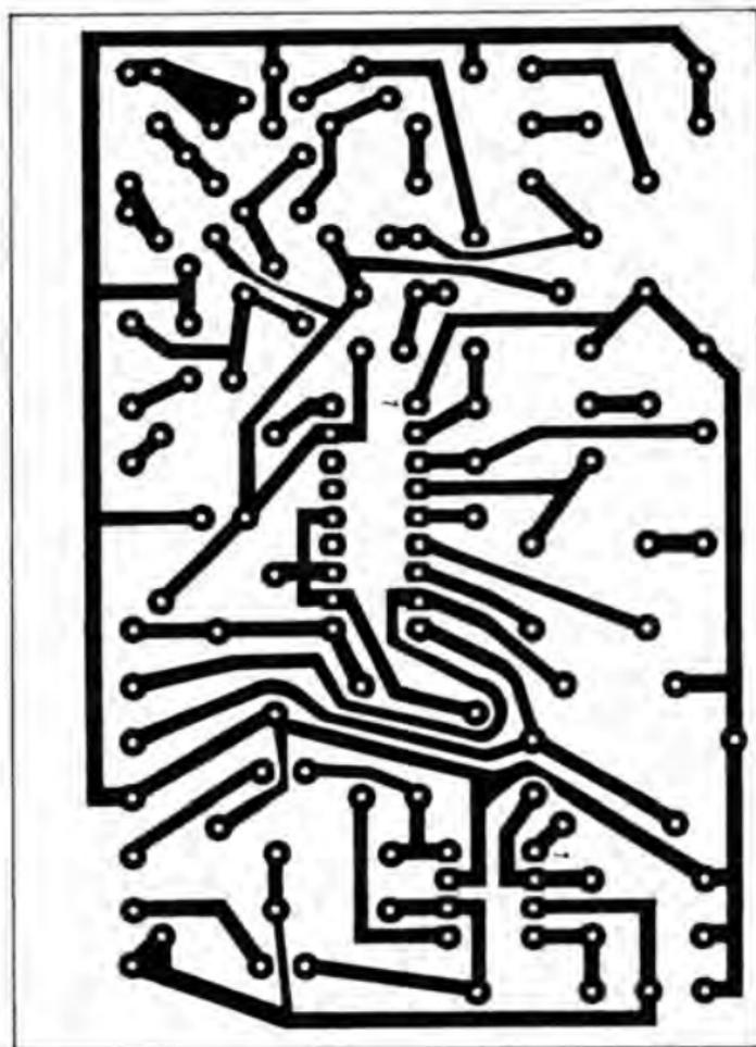
Bild 2.26 Leiterplattenentwurf zur Schaltung Bild 2.25
