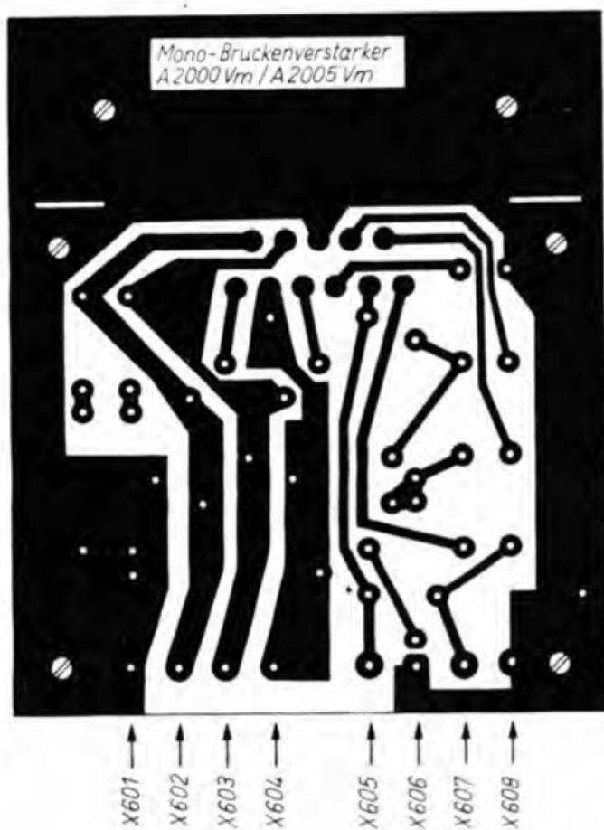
Bild 2.45 Leiterplatte für den Mono-Brückenverstärker
