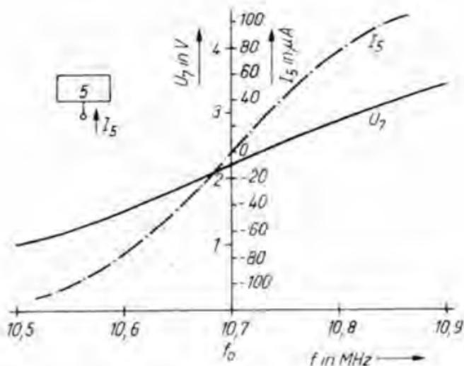
Bild 2.13 AFC-Strom und Ausgangsgleichspannung des NF-Ausgangs über der Frequenzablage um die Zwischenfrequenz.
