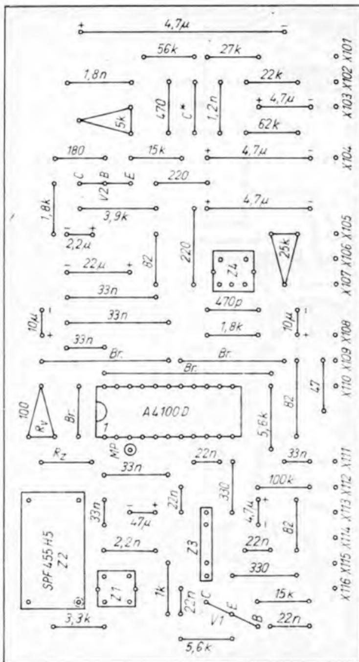
Bild 2.10 Bestückungsplan für A1 (Br. = Drahtbrücke)
