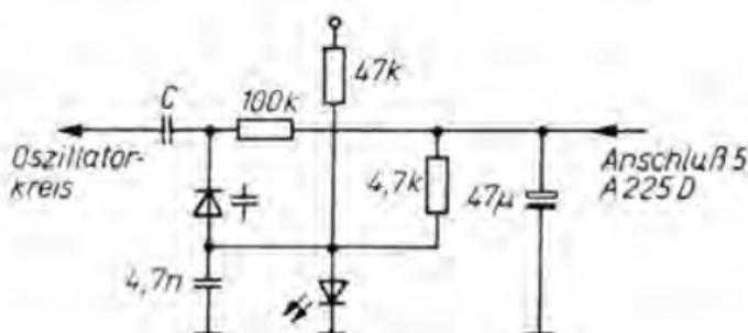
Bild 2.19 AFC-Schaltung für Drehkondensatorabstimmung
