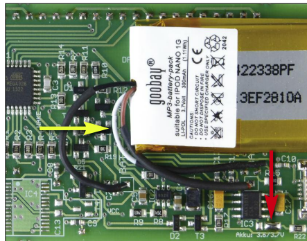
Bild 13: Korrekte Position des Akkumulators auf der Hauptplatine; der weiße Anschlussdraht bleibt isoliert und unbeschaltet. Die Lötbrücke 3,7 V (roter Pfeil) ist zu schließen.
