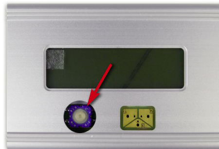
Bild 9: Der Tastschalter sitzt exakt mittig unter dem entsprechenden runden Durchbruch in der Gehäuseoberschale.
