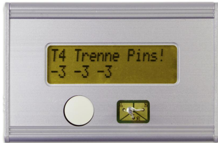
Bild 17: Diese Anzeige im Display fordert zum Entfernen der Kurzschlussbrücke auf, anschließend läuft der Kalibriervorgang automatisch weiter.
