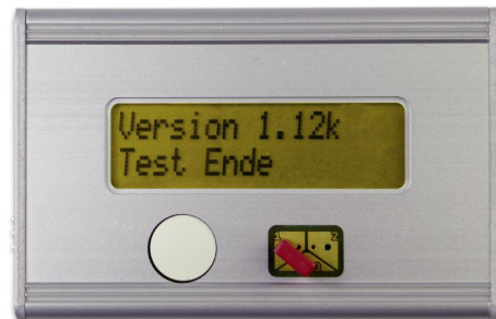
Bild 19: Testende, der Kondensator kann jetzt entfernt werden.
