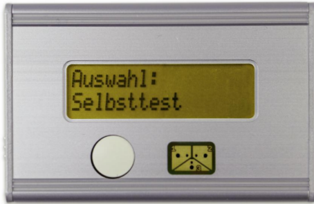
Bild 16: Selbsttest und Kalibrierung werden nach dem Kurzschluss der Messkontakte von diesem Menüpunkt aus gestartet.
