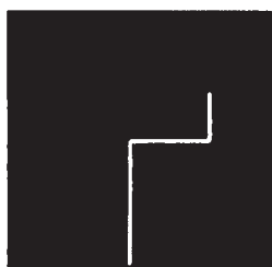
Z-Diode unter 8V
