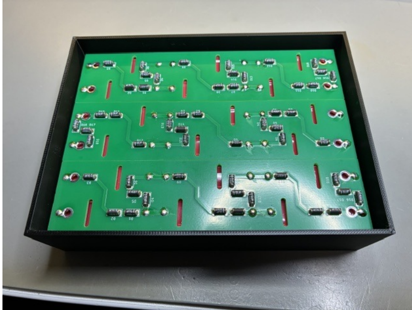
Abb. 2: Meine realisierte Kaskadenplatine im Modulgehäuse. Die Aufnahme dokumentiert den Aufbau der Leiterplattenbaugruppe.
