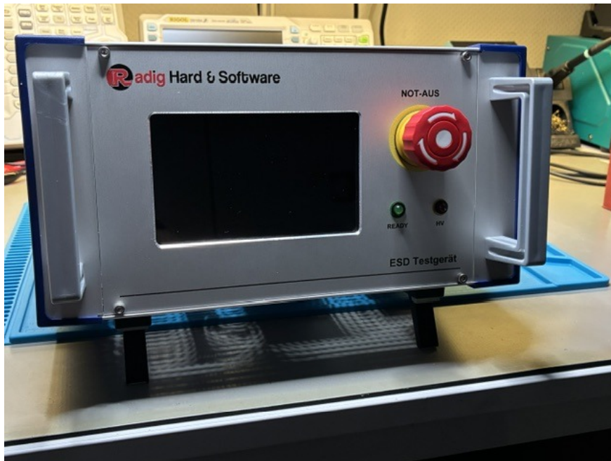
Abb. 1: Meine fertig beschriftete Gerätefront mit Touchdisplay, Not-Aus sowie READY- und HV-Leuchte.
