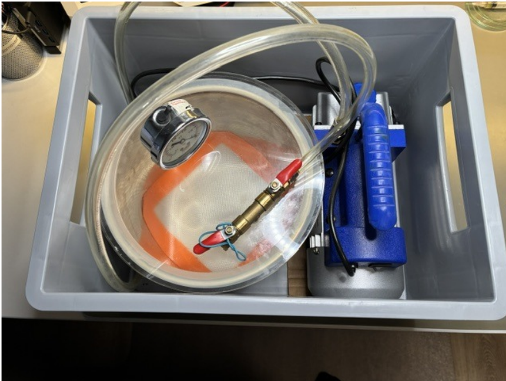
Abb. 6: Mein selbst aufgebautes Vakuumsystem mit Drehschieberpumpe, umgebautem Kochtopf, Manometer und Ventilen zum Entgasen des Vergusscharzes.
