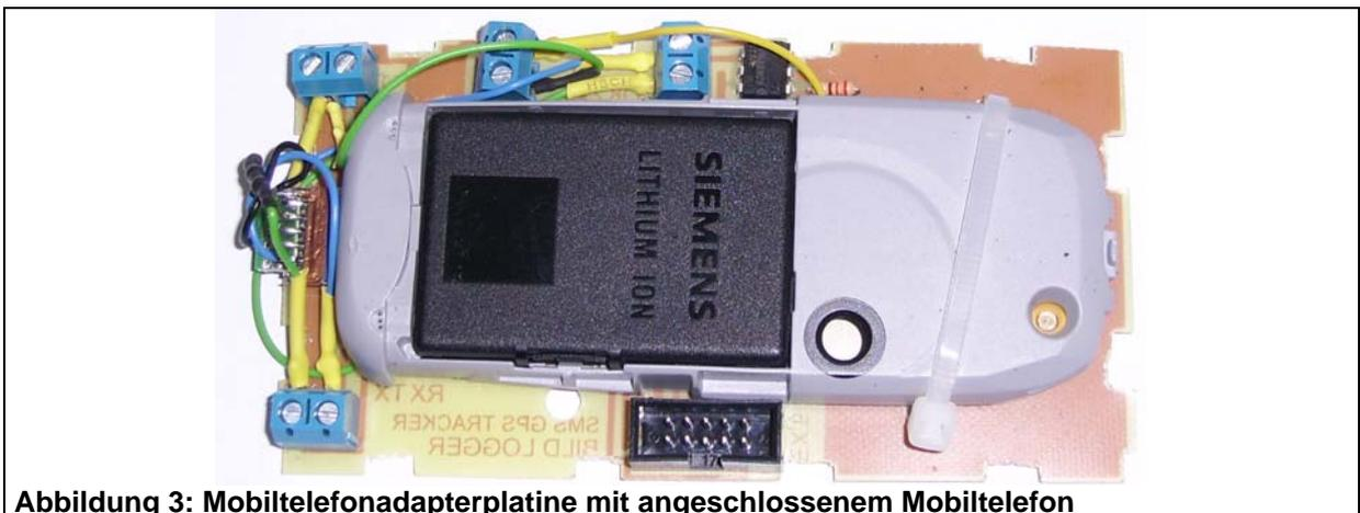
**Abbildung 3: Mobiltelefonadapterplatine mit angeschlossenem Mobiltelefon**
