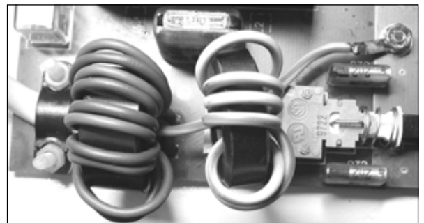
Bild 9: Gesamte angeschlossene Netzleitung mit montierten Ferrit-Ringkernen
