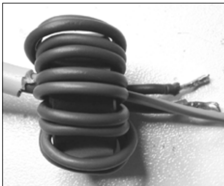
Bild 7: Ferrit-Ringkern mit durchgefädelten Leitungen
