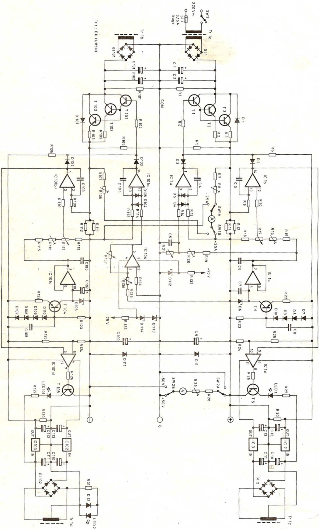
Bild 4. Der symmetrische Aufbau des Doppelnetzteils ist gut zu erkennen. Für die Transistoren T2 und T3 lassen sich sowohl die Typen MJ 15003 als auch 2N3773 (preiswerter!) einsetzen.
