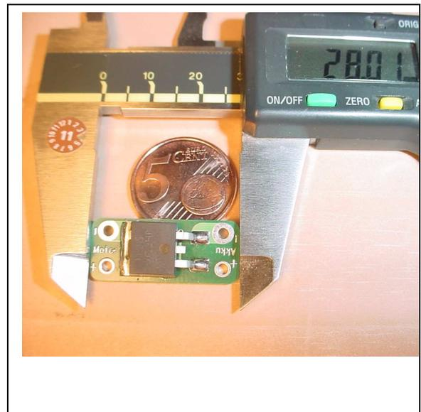
Wird das Modul „FETswirler“ eingesetzt, dann übernimmt der MOSFET-Transistor die eigentliche Schaltfunktion der Switchunit. Die Switchunit selber muss dann nur noch den Initialstrom für den Transistor schalten, und dieser ist kleiner als ein Millionstel. Außerdem ist im MOSFET-Transistor noch eine Revers-Diode integriert, diese Diode unterdrückt den Abrissfunken.
