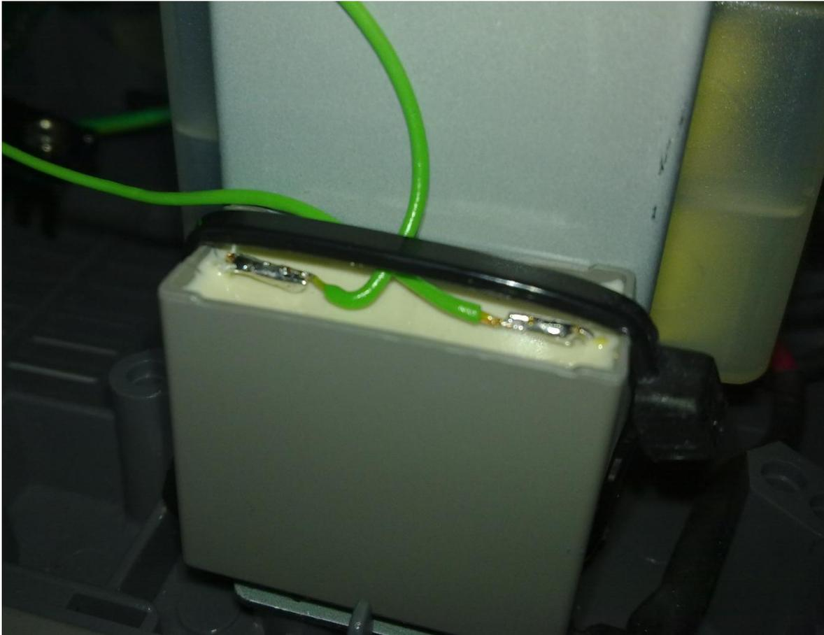
Die Beinchen des Kondensators mit den angelöteten Kabel habe ich entsprechend gekürzt und dann flach umgebogen. So konnte ich dann den Kabelbinder, der das Ding an Ort und Stelle hält, direkt über den Kondensator führen, ohne das die Beinchen oder Kabel dadurch abgeknickt werden könnten.
