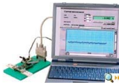
Bild 6. Für Entwicklungsaufgaben gibt es ein komplettes Testboard inklusive ASIC, 100- \Omega -Präzisionswiderstand und mit umfangreicher Windows-Mess- und Visualisierungssoftware, das an jedem PC über den parallelen Druckerport betrieben werden kann.
