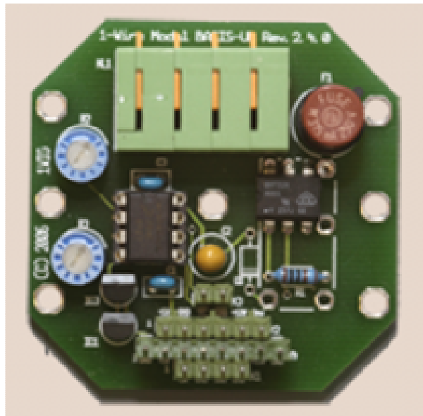
Abb.4.7: Komplettes 1-Wire-Sensor-/Aktor-Modul
