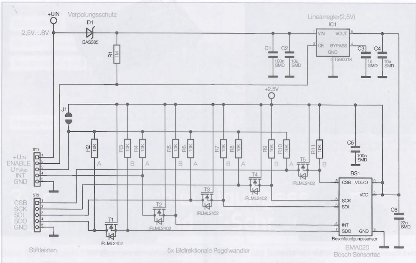
Bild 6: Schaltplan des 3D-BS-Moduls
