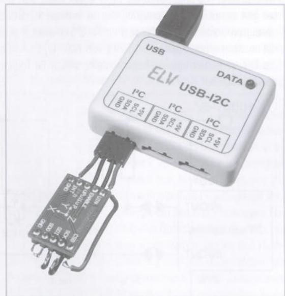
Bild 10: „Fliegende Verbindung“ des 3D-BS mit dem USB-I<sup>2</sup>C-Interface
