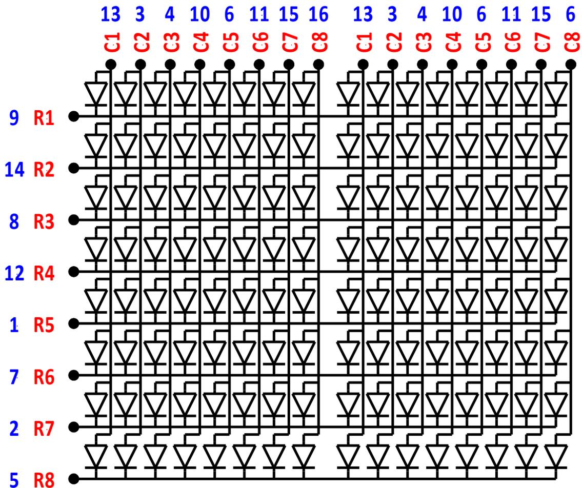
Ein grosses Problem bereiten die Matrix-LEDs. Im oberen Bild könnt ihr genau die Schaltung, Verbindungen und Anschluss an den HT16K33 erkennen. Es werden beide R1-R8 Anschlüsse parallel geschaltet. C1 -C8 werden jeweils getrennt an den HT16K33 angeschlossen.
