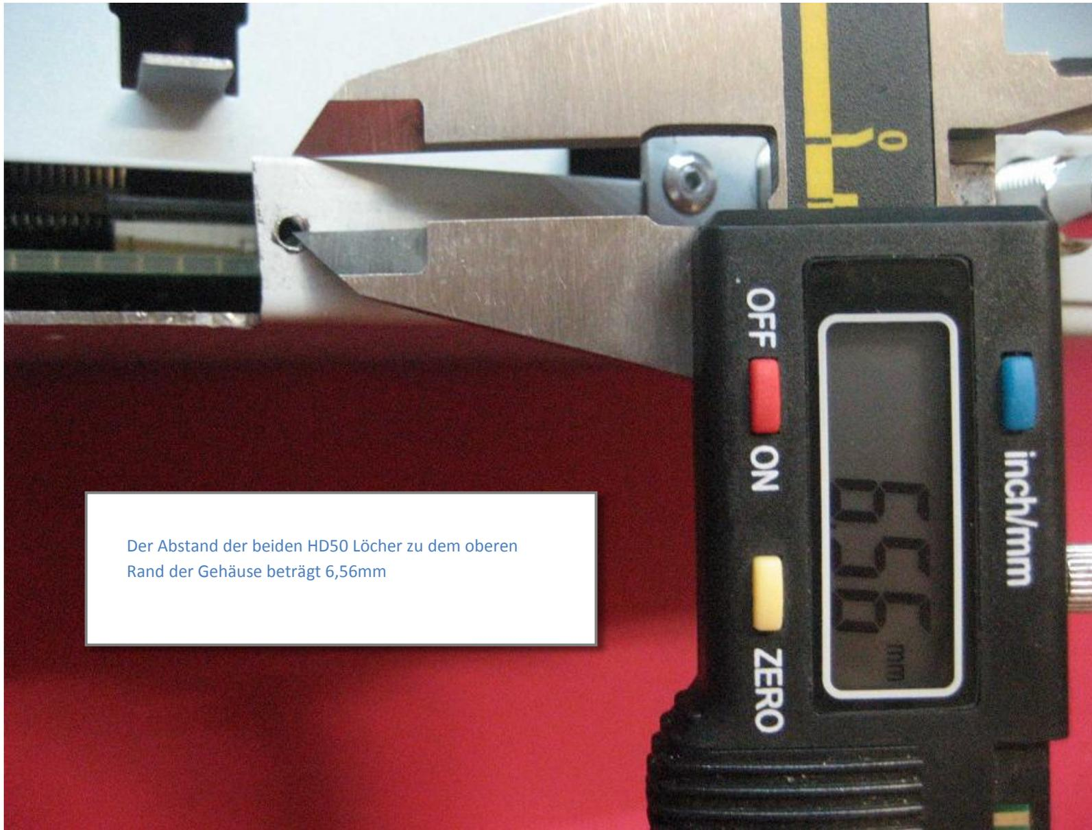
Der Abstand der beiden HD50 Löcher zu dem oberen Rand der Gehäuse beträgt 6,56mm
