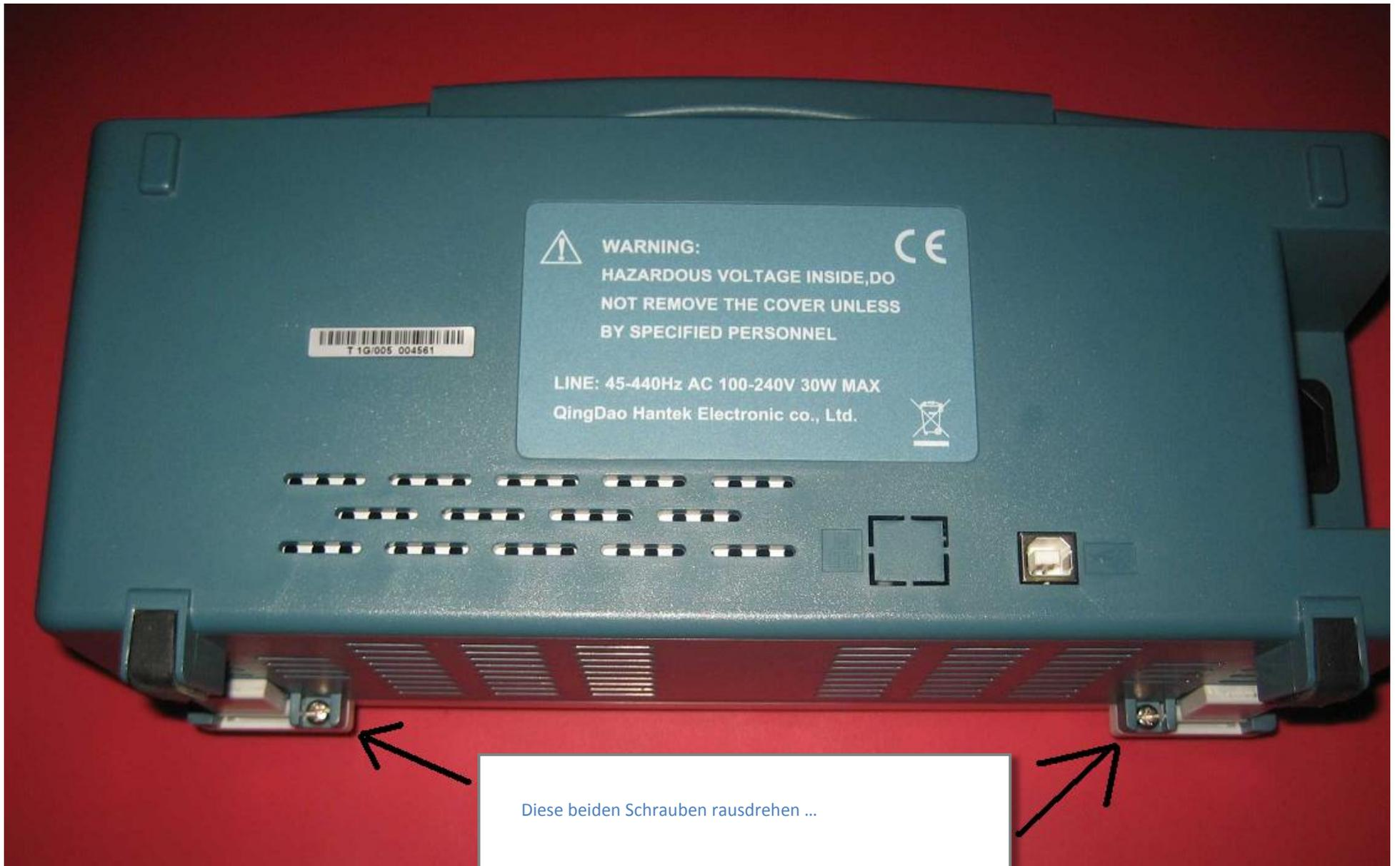
Diese beiden Schrauben rausdrehen ...
